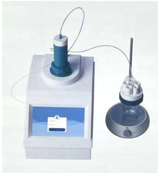
電位滴定儀是利用電位滴定法在滴定過程中測量電位變化以確定滴定終點方法的儀器。
