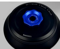
MC-D: 0.2ml/0.5ml/1.5ml/2ml×24 最高轉速: 15000rpm 最大相對離心力: 20519×g
