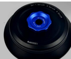
MC-D: 0.2ml/0.5ml/1.5ml/2ml×24 最高轉速: 15000rpm 最大相對離心力: 20519×g
