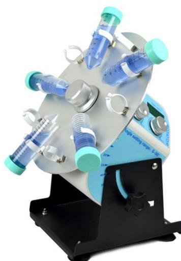
YM-80 旋轉培養混合器用於樣品的組織培養，萃取，測定沈降率，如：組織液混合、放射免疫、葡萄糖、蛋白質、DNA、細胞、尿液、酶等化學分析，在生化、生物、細胞、免疫、化學、動植物分析、臨床實驗等多方面都有廣泛應用。其主要特點是能夠勻速地長時間連續混合，它便於操作，轉盤的傾斜度可任意調節。它還可根據需要放置在恒溫箱內。
