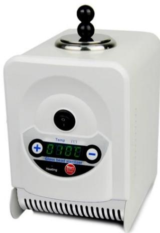
玻璃珠滅菌器是一款利用加熱的高溫玻璃珠，對小型實驗器材進行快速滅菌的產品。滅菌器外觀設計小巧緊湊，十秒鐘內能有效地對小型固體金屬與玻璃器具進行消毒滅菌，玻璃珠可加熱至 300°C 左右，高效地消滅細菌與孢子，常用於科研實驗室。
