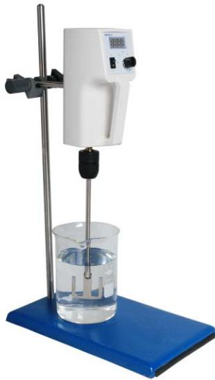
電動攪拌器產品設計新穎，採用交流感應電機電子控制測速電機回饋，低速運行，連續無段速度調整，不受樣品黏稠度的影響，轉速穩定，轉距輸出大，雜訊低。可以選購多種攪拌葉片型式，有槳式、輪式、鋸齒式、離心式、杆式、錨式、螺釘式等，更換方便、靈活，適用於生物、理化、食品、製劑等實驗室領域。
